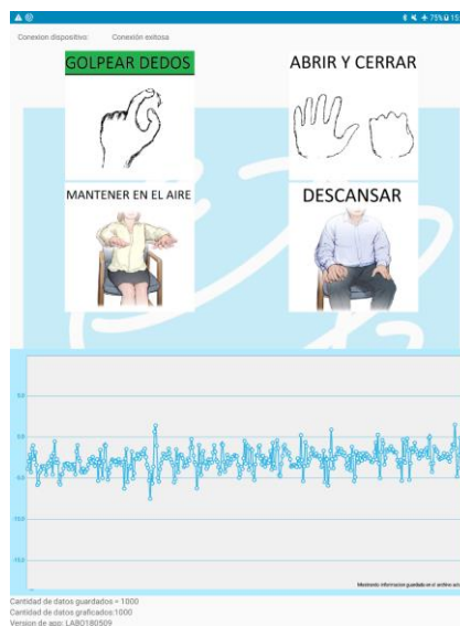
Fig. 2: Módulo App, versión doméstica. Interfaz intuitiva. Adquiere las señales y las almacena en el dispositivo.
