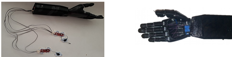
Figura 3: (A) Perspectiva del prototipo con sensores mioelectricos conectados. (B) Vista con el interior de la palma destapado. Puede observarse el mecanismo de tracción
