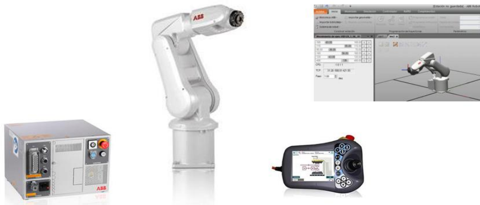
Figura 6: Controlador IRC5 Compact, Robot ABB IRB 120, paleta de programación (Flex Pendant) y vista de la interfaz de simulación, del sistema robótico adquirido
